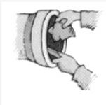
2.- Lubricar la superficie interior de la campana y la exterior del tubo, usando un cepillo, esponja o guantes para cubrir la superficie entera. El lubricante debe ser el adecuado.
